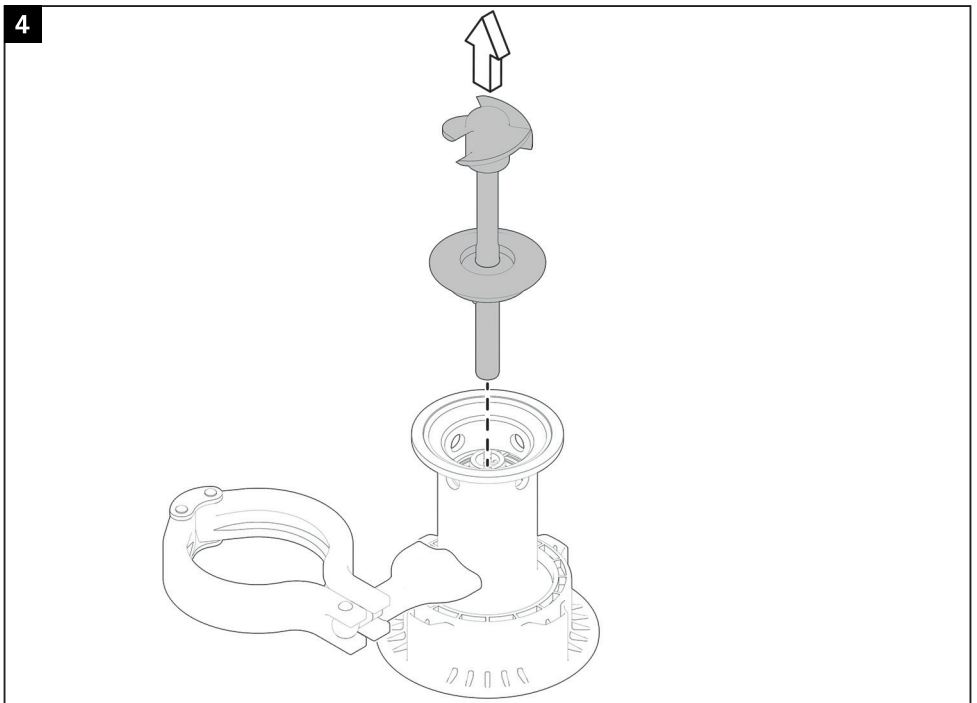
Abbildung: Demontage der Pumpe
